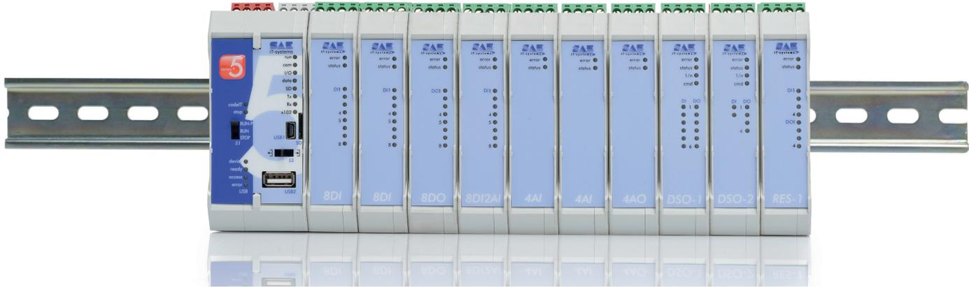
Das net-line FW-5-GATE-4G kann mit bis zu 12 Erweiterungsbaugruppen (EWB) flexibel und bedarfsgenau über ein internes Bus-system ergänzt werden. Sollte die Stromversorgung der Basisstation nicht ausreichen, so kann der Strombooster PWR-1 weitere 2,8 A bereitstellen. Die TBUS-Verlängerung erlaubt auch abgesetzte EWB als remote I/O einzubinden. Basiseinheit und alle Module außer PM-1 sind mit steckbaren Klemmen in Schraub- oder Federklemmtechnik ausgeführt.
