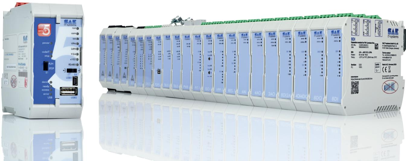
Das Mengengerüst des SAE-FW-5-GATE kann anwendungsorientiert mit bis zu 12 Erweiterungsbaugruppen (EWB) ausgebaut werden. Mit dem Zubehör TBUS-T und TBUS-R können die EWB auch dezentral vom Basissystem abgesetzt platziert werden. Bei Konstellationen mit einem Strombedarf oberhalb der Möglichkeiten der Basiseinheit, kann die Stromversorgungsbaugruppe PWR-1 ergänzt werden.
