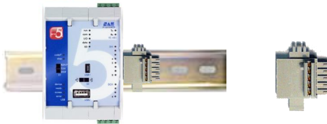
Abbildung 18: T-BUS Verbindungsstück zu Erweiterungsmodulen
